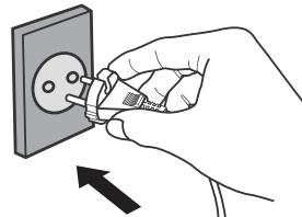
■ Поскольку датчик запаха определяет текущую степень чистоты после вставки вилки в розетку, как стандартную, рекомендуется вставлять вилку в розетку, когда воздух чистый (когда отсутствует сигаретный дым). (Стандартное состояние датчика запаха автоматически обновляется в соответствии со степенью чистоты в помещении).
