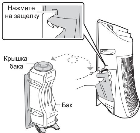
(2) Отверните крышку бака, затем наполните бак водой.
