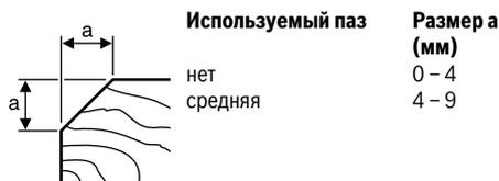
**Строгание с параллельным/угловым упором (см. рисунки F – H)**
