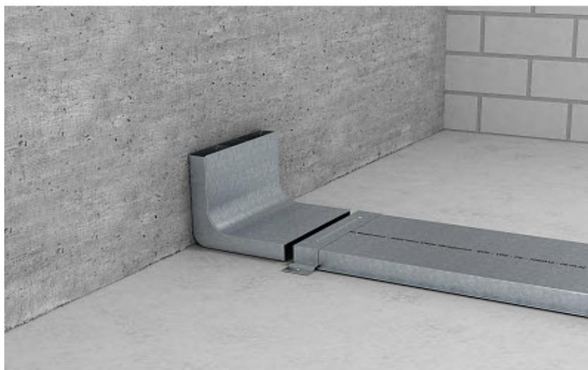
Vertikalkrümmen dienen als Wandanschlüsse zur Einführung der Kabel und Leitungen in das Unterflursystem. Der Anschluss erfolgt über einen Kanalverbinder.
