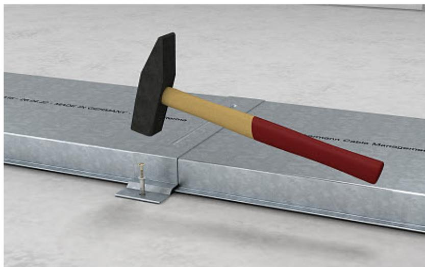
Die Unterflurkanäle werden mit Hilfe der Verbindungslasche auf dem Untergrund befestigt. Eine zusätzliche Befestigung der Kanalstrecken zwischen den Verbindungslaschen ist nicht notwendig, kann bei Bedarf aber mit Hilfe der Befestigungslasche **BL1** erfolgen.
