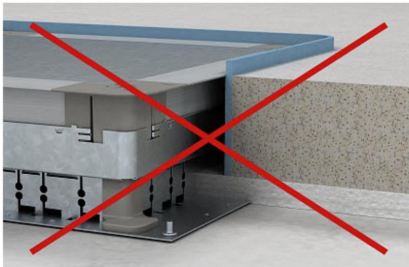
Wie schon vorab angemerkt, sollte auf jeden Fall eine Absprache mit dem Estrichlegergewerk stattfinden. Es dürfen keine Randdämmstreifen so um den Dosenkörper gelegt werden, dass dieser von Estrich entkoppelt ist!!
