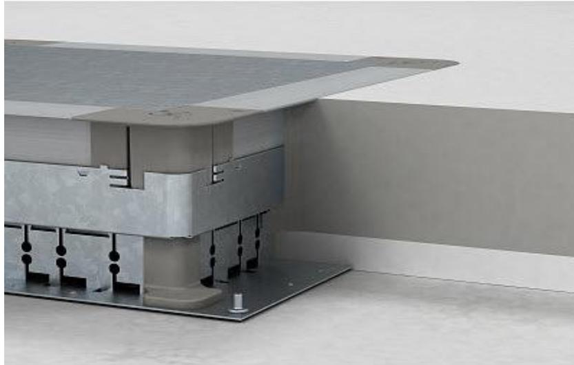
Der eingebrachte Estrich kann direkt an die Unterfluranschlussdose reichen. Es ist darauf zu achten, dass der Überstand am Dosenoberrahmen mit Estrich vollflächig unterfüttert wird. Bei Gussasphalt und erdfeuchtem Estrich muss das Material unter dem Rahmen verdichtet werden; bei Fließestrich dürfen keine Hohlräume entstehen!
