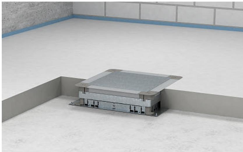
Die Standard-(Basis)-Unterfluranschlussdose haben eine Mindestbauhöhe von 70 mm und einen Nivellierbereich von +55 mm. Um höhere Bodenaufbauten abdecken zu können, stehen Unterfluranschlussdosen mit entsprechenden Verstellbereichen zur Verfügung. Sollten die Unterflurdosen schon in der Kanalstrecke fest montiert sein, können die UFD alternativ mit Aufstockhilfen vom Typ **ASH**....an den entsprechenden Bodenaufbau angepasst werden.
