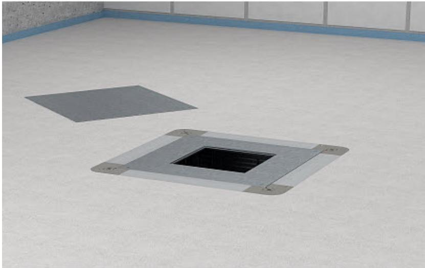
Steht die Bestückung und der Bodenoberbelag fest, wird durch den Austausch des Montageschutzdeckels und Einbau eines Montagedeckels **DUG..** aus der Zug- und Abzweigdose **UZD...** eine Gerätedose **UGD....**
