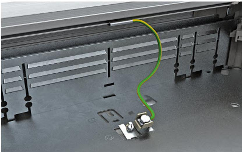
Um die Unterfluranschlussdose bzw. das gesamte Kanalsystem in die Schutzmaßnahme mit einzubeziehen sind im Bodenblech der UFD Laschen ausgeprägt in welche der Schutzleiteranschlusswinkel 8AWR montiert werden kann (Hinweis: Anschlussdrehmoment 1,3 N).
