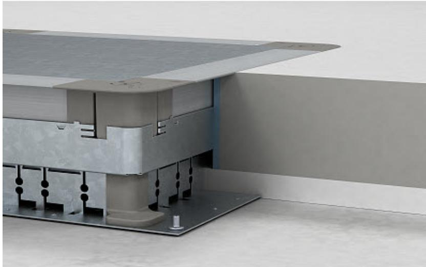
Sollte beim Einsatz in schwimmend verlegten Estrichen/Heizestrichen auf Dämmschichten eine Trennlage gefordert sein kann der Dosenkörper durch einen Dämmstreifen (3-5 mm stark), vom Estrich getrennt werden. Wichtig ist, dass diese Trennlage bis **max.** unter den Dosenberrahmen eingebracht werden darf!
