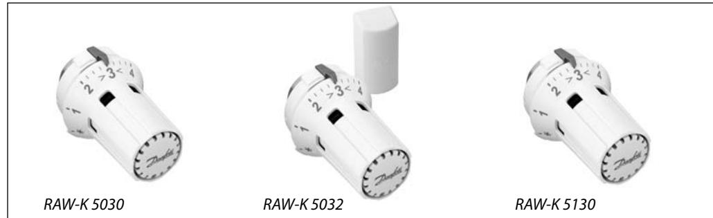
Терmostатические элементы серии RAW-K — автоматические регуляторы температуры с малой зоной пропорциональности. RAW-K предназначены для установки на клапаны терморегуляторов фирм Heimeier, Oventrop или MNG, встроенные в конструкцию стальных панельных радиаторов типа Biasi, Delta, DiaNorm, Diatherm, Ferroli, Henrad, Kaimann, Kermi, Korado, Purmo, Radson, Superia, Stelrad, Veha, Zehnder-Completto Fix.
