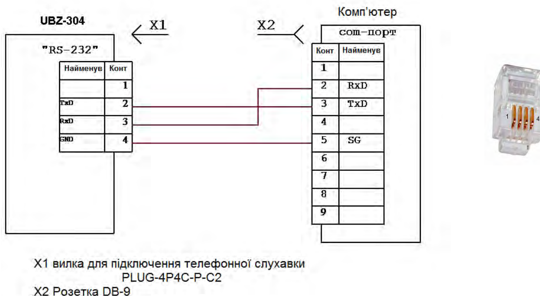
Рисунок 5.12 - Схема підключення UBZ-304 до ПК
