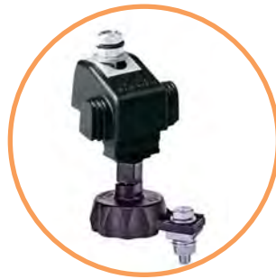
→ Зажим тип "S" с проколом изоляции с одной стороны, оснащённый болтом со срывной головкой и возможностью установки под напряжением, 10 - 150 mm 2
