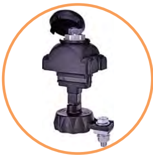
→ Зажим тип "F" с проколом изоляции с двух сторон, оснащённый болтом со срывной головкой и возможностью установки под напряжением, 10 - 95 mm 2
