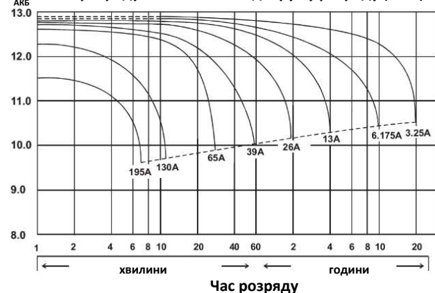
Час розряду в залежності від струму розряду (25°C)
