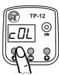
Кнопкой или измените значение режима нагрузки: «*h0t*» - Нагрев, «*c0l*» - Охлаждение
