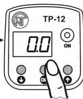
Нажмите кнопку **OK** для входа в параметр, при этом на дисплее отобразится заводская установка параметра в мигающем режиме (*0.0*)
