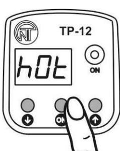
Нажмите кнопку **OK** для входа в параметр, при этом на дисплее отобразится заводская установка параметра в мигающем режиме (*h0t*)
