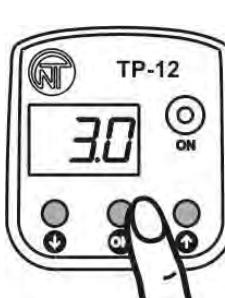
Нажмите кнопку **OK** для входа в параметр, при этом на дисплее отобразится заводская установка параметра в мигающем режиме (*3.0*)
