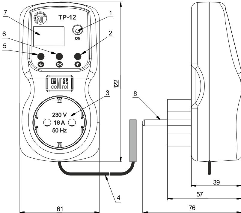
1 – светодиод **ON** горит при наличии напряжения в розетке ТР-12;
