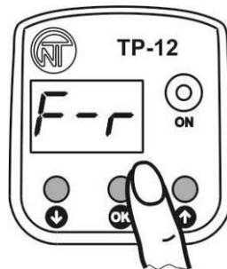
Нажмите кнопку **OK** для сброса всех настраиваемых параметров к заводским установкам, при этом на дисплее отобразится параметр меню «*F-r*» (если удерживать нажатой кнопку **OK** в течение 3 секунд, Вы выйдете из меню сброса к заводским установкам и изделие перейдет кциальному режиму работы). Для выхода из меню удерживайте нажатой кнопку **OK** в течение 3 секунд
