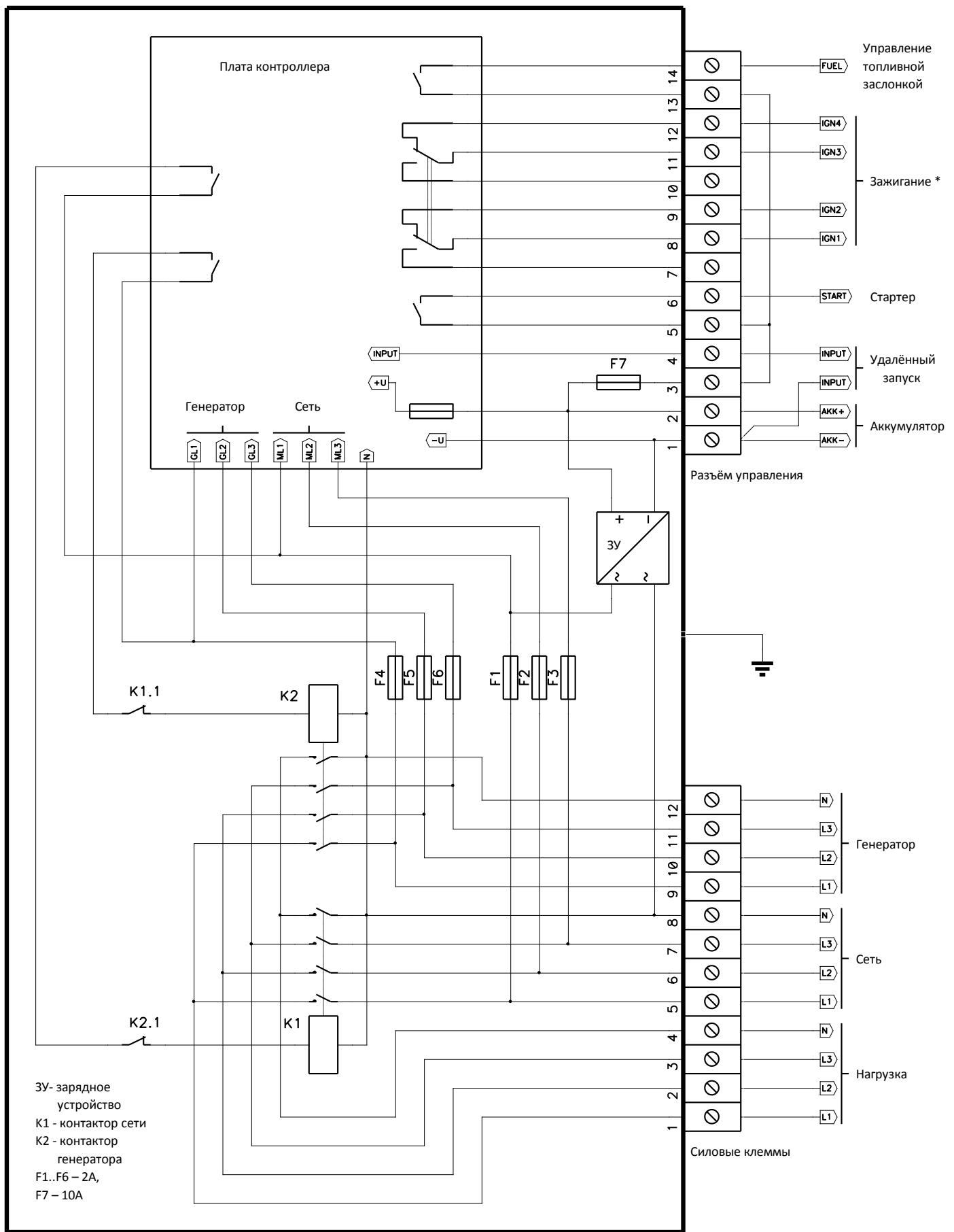
Рис 6.2. Пример схемы подключения контроллера АВР33МЕ.
