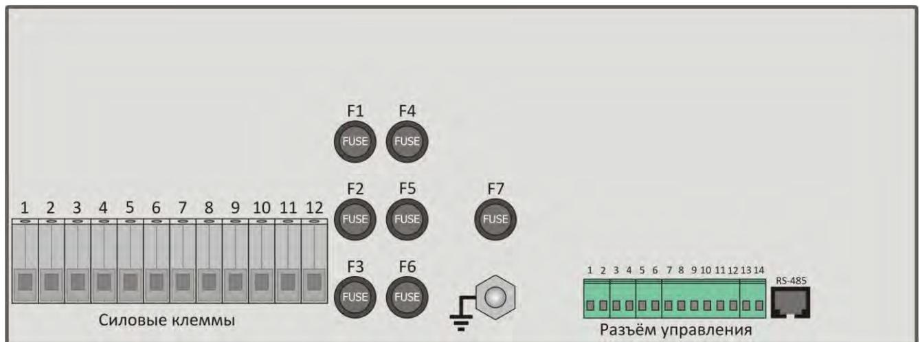
Рис 6.1. Предохранители, клеммы и разъём подключения контроллера.
