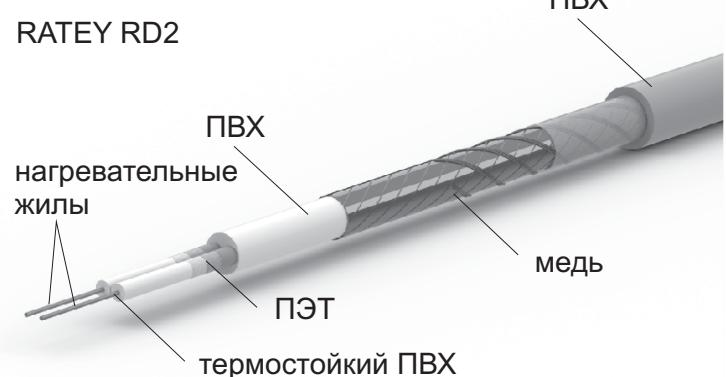
**В одножильном кабеле RATEY** трехслойная герметичная изоляция выполнена из современных высококачественных материалов и предназначена для изоляции нагревательной жилы от экрана. Изоляция кабеля не теряет своих свойств при высокой температуре греющей жилы в течение всего срока эксплуатации. Экран навит из медных и стальных проволок.
