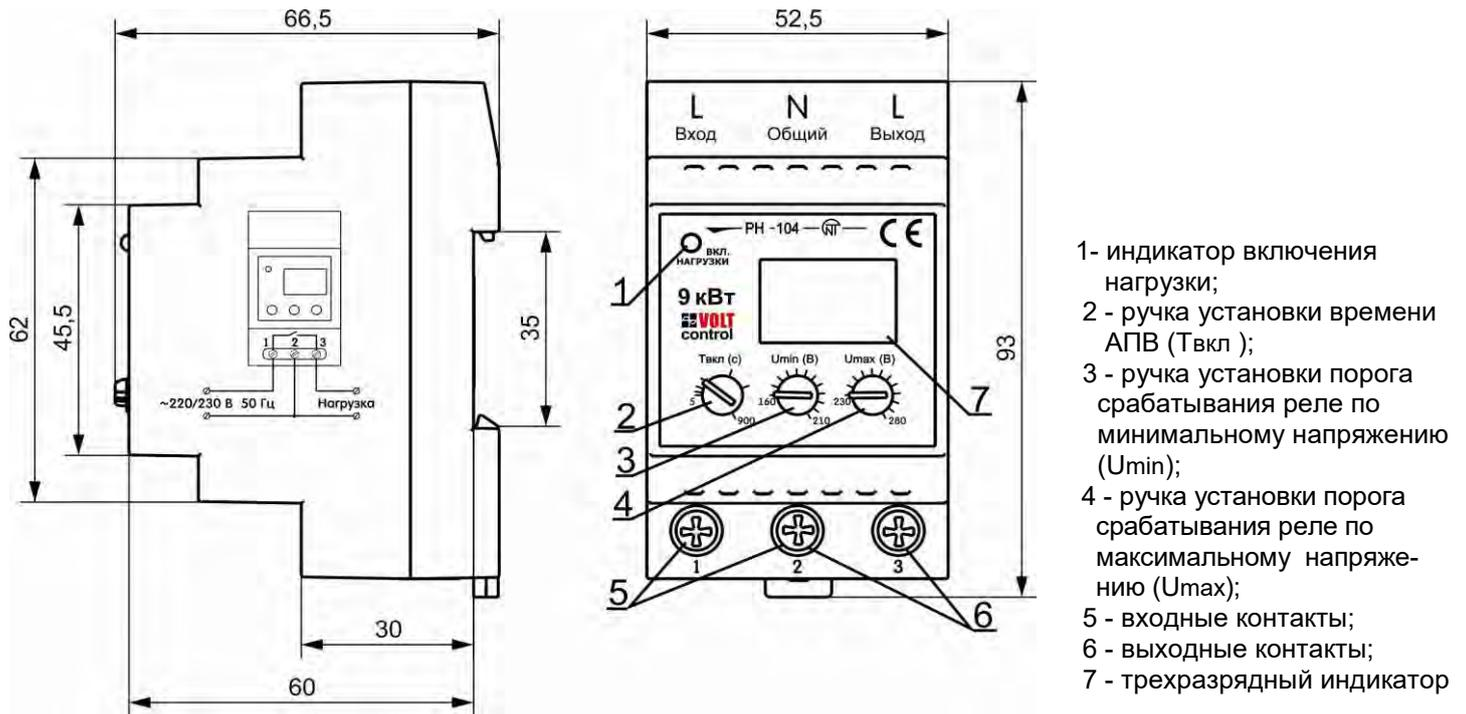
Рисунок 1 – Органы управления и габаритные размеры
