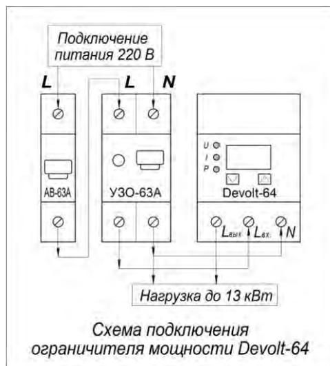
Установить выключатель автоматический (АВ) и устройство защитного отключения (УЗО) в положение ВКЛ. Вольтметр покажет напряжение в сети и будет мигать (мигание означает, что напряжение на выходе прибора отсутствует). Если напряжение в сети в пределах нормы, устройства защиты через время заданное в нем подключит электроприбор к сети и вольтметр перестанет мигать.
