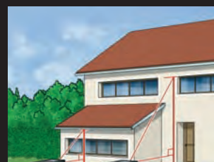
ОПРЕДЕЛЕНИЕ ВЫСОТЫ: по двум или трем точкам
