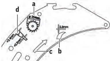
**a** Максимальный допустимый диаметр пильного диска составляет 254 мм.
