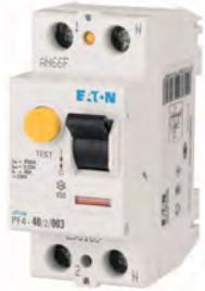
Устройство защитного отключения 40/0,3А (AC), 2 полюса, устойчивость к импульсному току 250А, устойчивость к КЗ 4,5 кА
