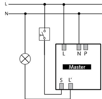
**Параллельная схема Master-Slave**
