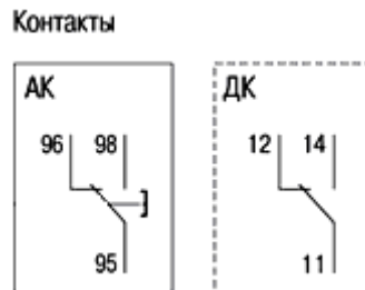
Рисунок 11 — Электрические схемы дополнительного и аварийного контактов
