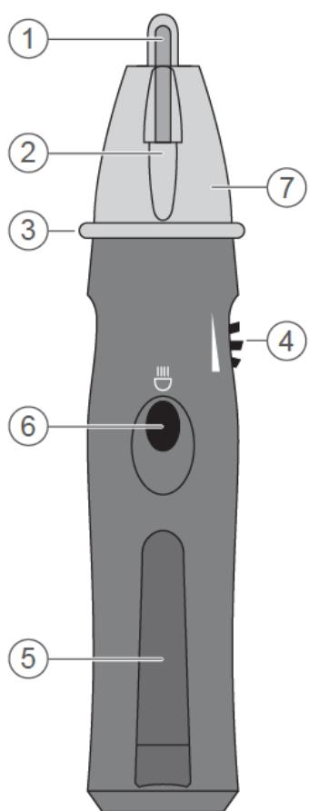
1. Щуп – використовують для виявлення напруги змінного струму.
