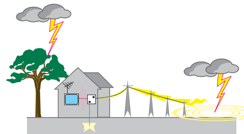
Pośrednie, odległe wyładowanie piorunowe - uderzenie w sąsiadujące obiekty, zjawiska indukcyjne Impuls 8/20 \mu s
