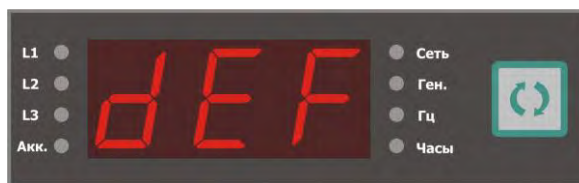
Рис. 5.8. Индикация установки параметров по умолчанию.
