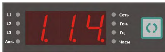
Рис. 5.6. Пример: параметр №114, доступный для редактирования значения.
