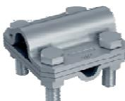
Затискач з нержавіючої сталі з гвинтами M8 дозволяє з'єднати стержень заземлення з заземлюючим провідником - круглим проводом або смugoю 25..40 мм.
