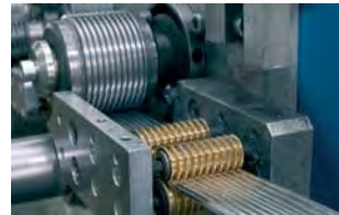
Цех изготовления гибких воздуховодов
