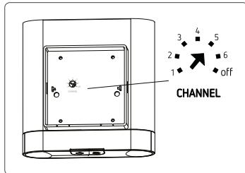
❶ Настройка с помощью потенциометра также применяется к светильникам без датчиков движения.
