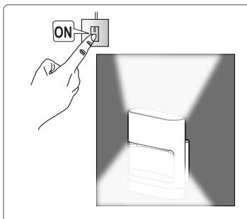
① Время «прогрева» прибора после подключения к сети ок. 40 с.
