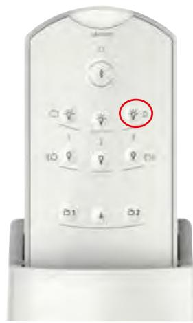
① Обнаружение движений выключено. Светильник включается автоматически, когда естественная освещенность ниже установленного порога срабатывания.
