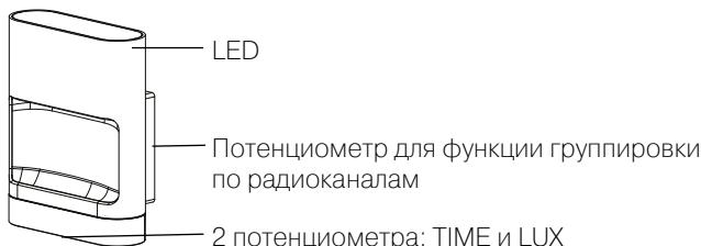
① Светильник с датчиком движения имеет 3 потенциометра для настройки времени отключения (TIME), порога срабатывания по освещенности (LUX) и функции группировки светильников по радиоканалам.
