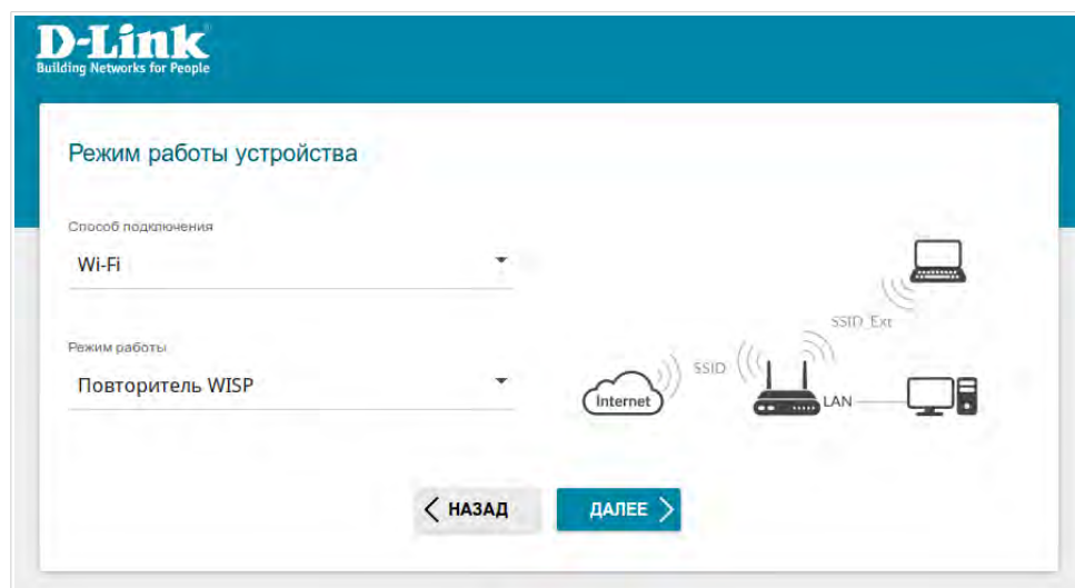
Рисунок 24. Выбор режима работы устройства. Режим Повторитель WISP .
