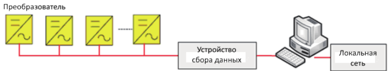
Рис. 9: Устройство сбора данных и монитор ПК осуществляют контроль через интерфейс RS485
