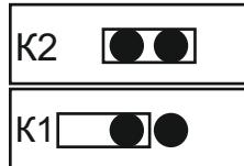
Разъем K1: перемычка установлена на левом контакте
