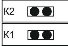
Установлены перемычки для разъемов K1 и K2
