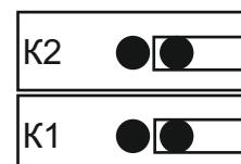
Разъемы K1 и K2: перемычки установлены на правом контакте
