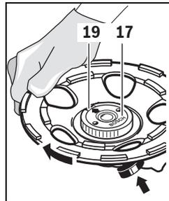
Нажмите на кнопку блокировки шпинделя **9** для его фиксации. Для затягивания быстрозажимной гайки поверните алмазный чашечный круг с усилием по часовой стрелке.
