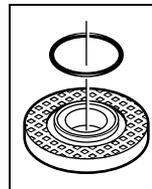
В опорному фланці **14** на центруючому пояску знаходиться пластмасова деталь (кілець круглого перерізу). **Якщо кілець круглого перерізу відсутнє або пошкоджене**, опорний фланець **14** необхідно обов'язково замінити перед подальшим використанням.
