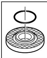
На опорном фланце **14** вокруг центрирующего буртика находится пластмассовая деталь (кольцо круглого сечения). Если кольцо круглого сечения отсутствует или повреждено, опорный фланец **14** необходимо обязательно заменить перед дальнейшим применением.
