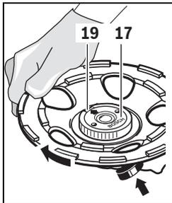
Натисніть на фіксатор шпинделя **9**, щоб зупинити шліфувальний шпиндель. Для затягнення швидкозатискної гайки з силою поверніть алмазний чашковий круг за стрілкою годинника. Закріплену належним чином, непошкоджену швидкозатискну гайку можна відпустити, вручну повертаючи кільце з
