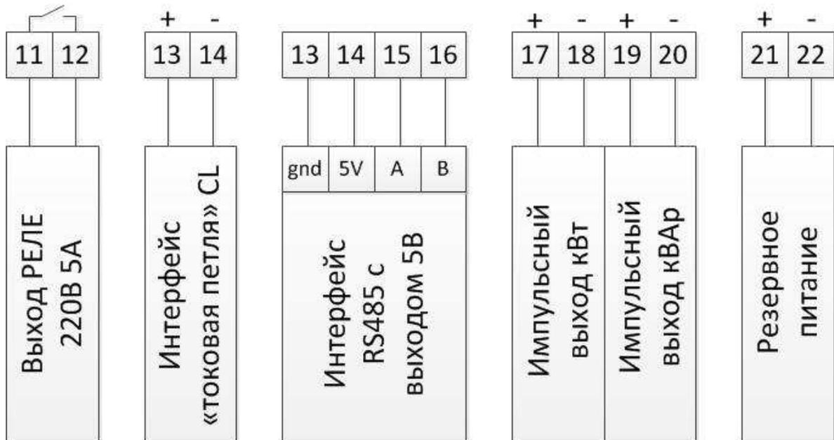
Рисунок Б.2 – Схема подключения интерфейсов счетчика 2303L...E
