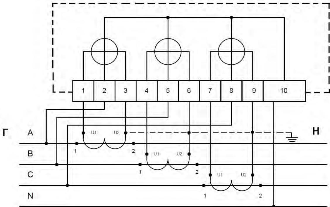
Рисунок Б.4 – Подключение счетчиков комбинированного подключения
