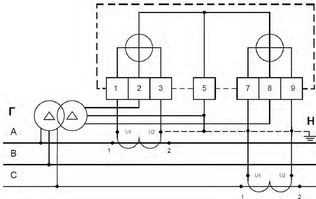
Рисунок Б.5 – Подключение счетчиков трансформаторного подключения
