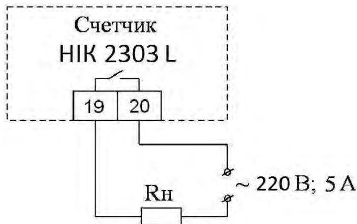
R<sub>н</sub> – нагрузка, которая подключается до релейного выхода.
