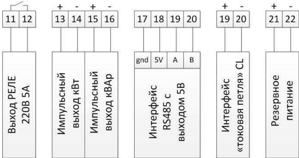
Рисунок Б.1 – Схема подключения интерфейсов счетчика 2303L
