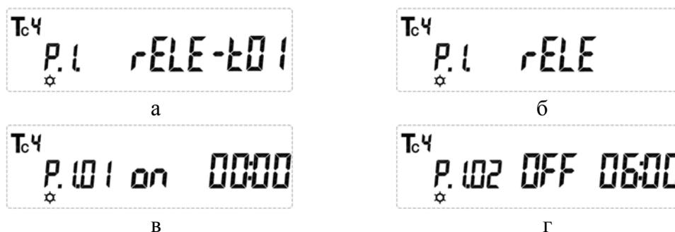
Рисунок 2.5 – Параметры работы релейного выхода
