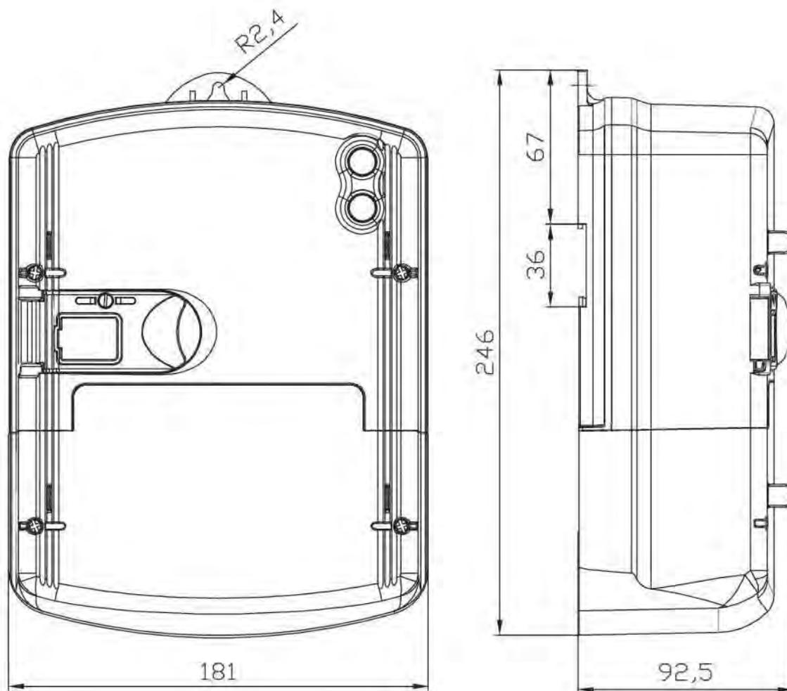
Рисунок А.2 – Габаритные и установочные размеры счетчиков НІК 2303L...Е
