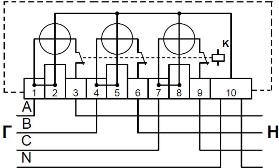
Рисунок Б.3 – Подключение счетчиков прямого подключения
