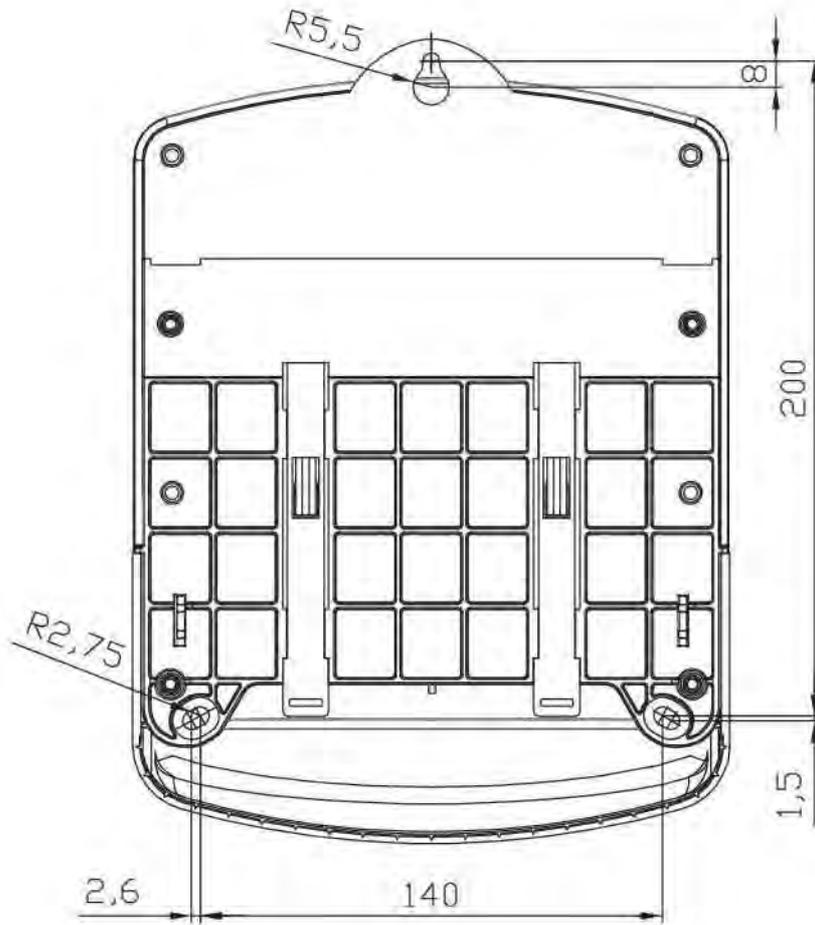
Рисунок А.2- Габаритные и установочные размеры счетчиков НІК 2303L...Е
