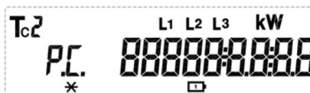
Рисунок 2.12- Просмотр параметров реле управления нагрузкой
