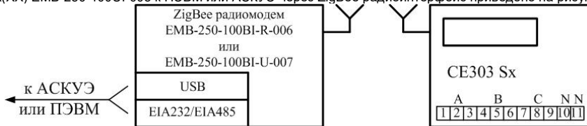
Рисунок 3.8 - Схема подключения счетчика
