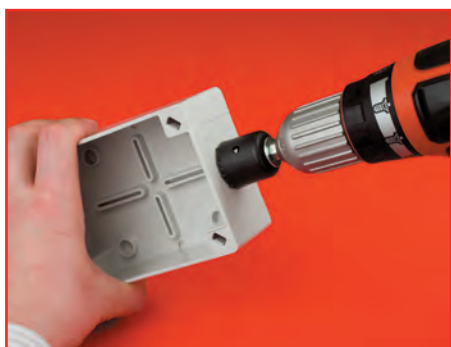
1 этап. Сверлим отверстия необходимого диаметра
