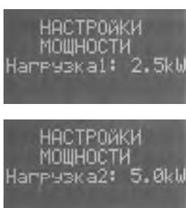
Рис. 29 – Экран настройки мощности нагревателей
