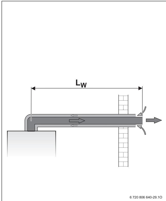
Рис. 8 Горизонтальный отвод дымовых газов по C<sub>12c</sub> концентрической трубой
