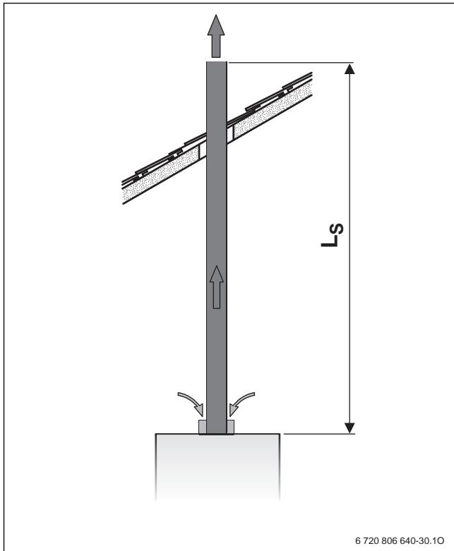
Рис. 7 Вертикальный отвод дымовых газов по B<sub>22</sub>
