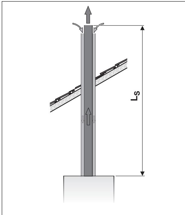
Рис. 9 Вертикальный отвод дымовых газов по C<sub>32c</sub> концентрической трубой
