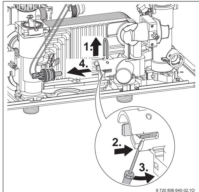
Рис. 40 Демонтаж датчика температуры горячей воды (вид на котёл сзади)
