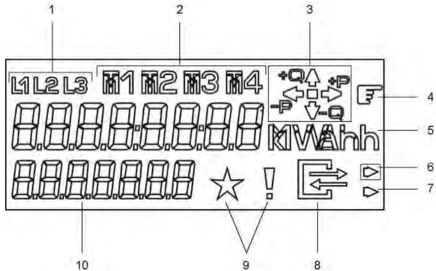
Рисунок 12: Схема дисплея
