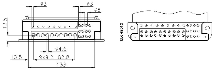
Рисунок 3: Контактная группа для счетчика трансформаторного включения
