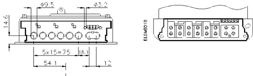
Рисунок 5: Контактная группа для счетчика прямого включения 100 А
