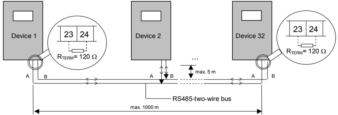
Рисунок 8: План системы - двухпроводная шина RS485
