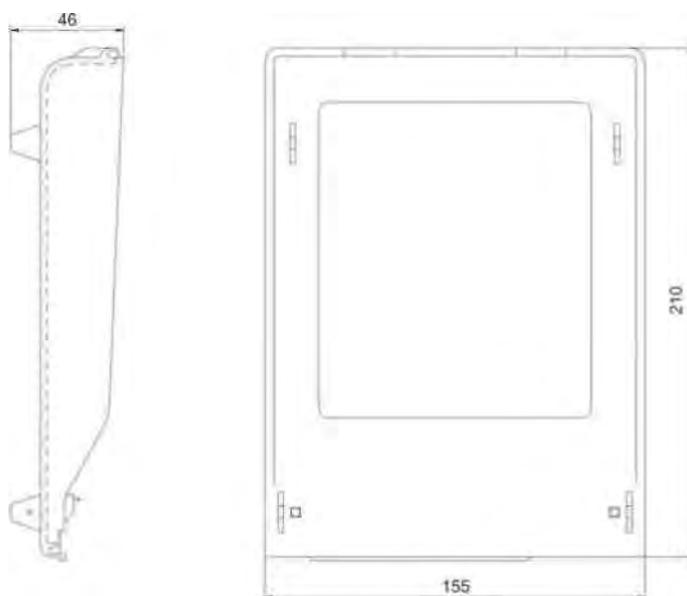
Рисунок 10: Крышка счетчика
