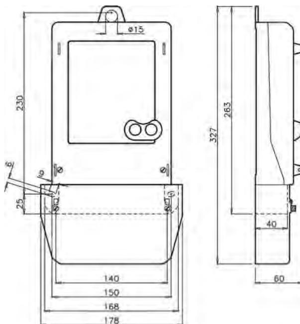
Рисунок 1: Размеры счетчика
