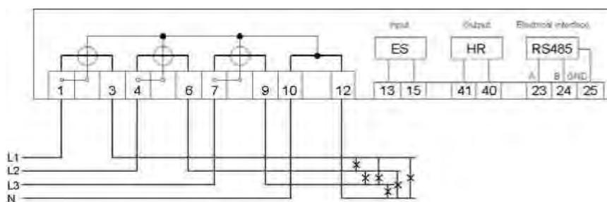
Рисунок 2: Схема соединения
