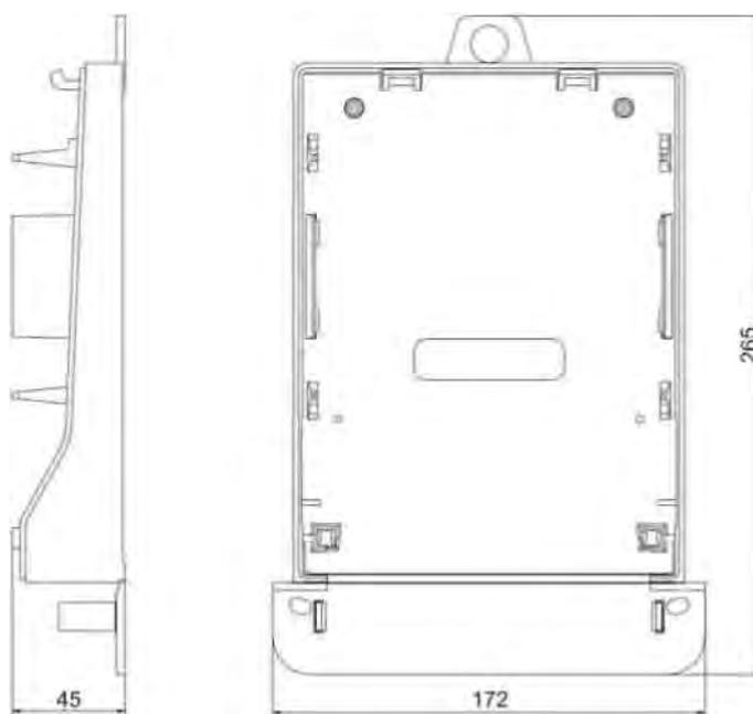
Рисунок 9: Установочная плата
