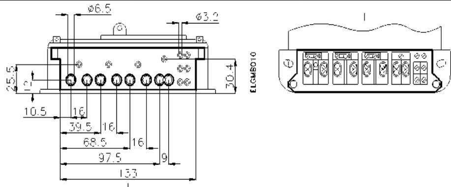
Рисунок 4: Контактная группа для счетчика прямого включения 60 А
