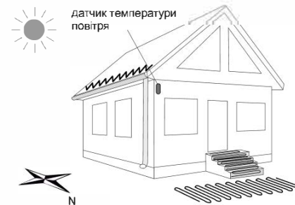
Рисунок 1. Монтаж датчика температури повітря
