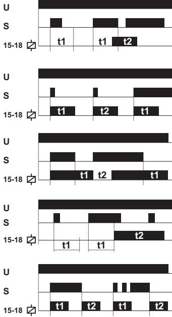
**20. Затримка включення/відключення (без можливості скидання)** – керуючий сигнал вимикає реле (позиція 15-16), в той же час починається вимірювання часу t1. Після закінчення часу реле вимикається. Після зниження імпульсу починається відлік часу t2, після закінчення якого реле вимикається. Поновлення керуючого сигналу не впливає на систему. Якщо тривалість імпульсу коротша за час t1, то реле не вмикається.
