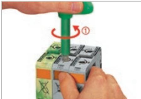
Поверните торцевой ключ против часовой стрелки до упора ①. Затем вдавите оранжевую защелку для монтажа проводника.
