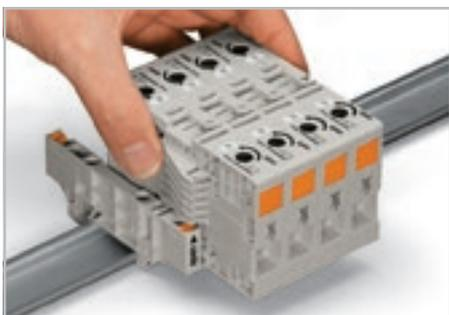
Снятие сборки: Поверните фиксаторы монтажного адаптера в положение «разомкнуто». Выдвиньте сборку из монтажных адаптеров и снимите ее.
