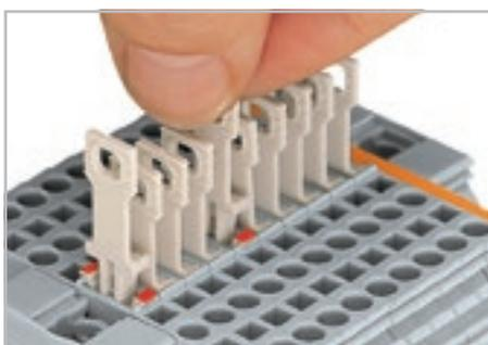
Установка стопора вручную.
