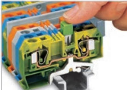
Объединение перемычками клемм с заземлением и проходных клемм возможно только в одном направлении (с задней стороны клеммы) с использованием перемычек для смежных клемм. Кроме обязательной маркировки таких блоков, следует использовать желто-зеленые поперечные перемычки.
