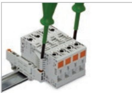
Снятие сборки: Вставьте два инструмента в слоты разделительной перегородки между вилкой и розеткой и расфиксируйте сборку.
