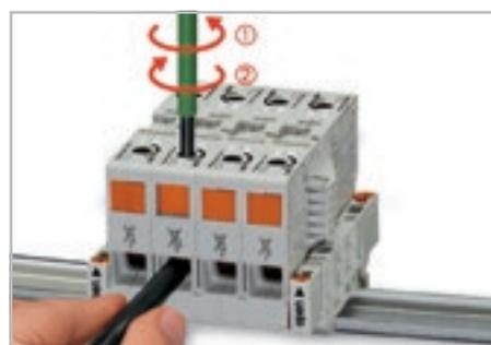
Разблокируйте защелку коротким поворотом против часовой стрелки; после разблокировки поверните инструмент по часовой стрелке для надежного зажима проводника.
