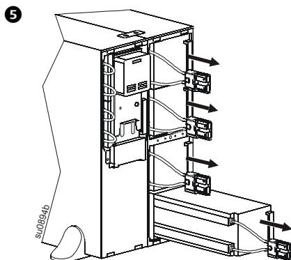
**6** Отсоедините и снимите модуль батарей с ИБП. См. раздел “Изменение вертикальной конфигурации на конфигурацию для монтажа в стойку” на стр. 14.
