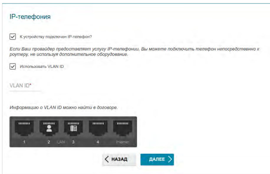
Рисунок 41. Страница выбора LAN-порта для подключения VoIP-телефона.
