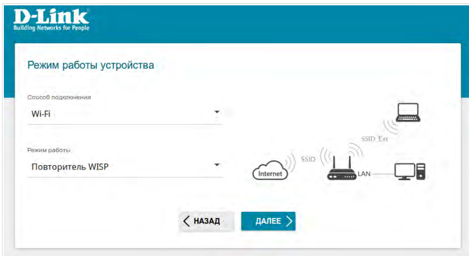
Рисунок 26. Выбор режима работы устройства. Режим Повторитель WISP .
