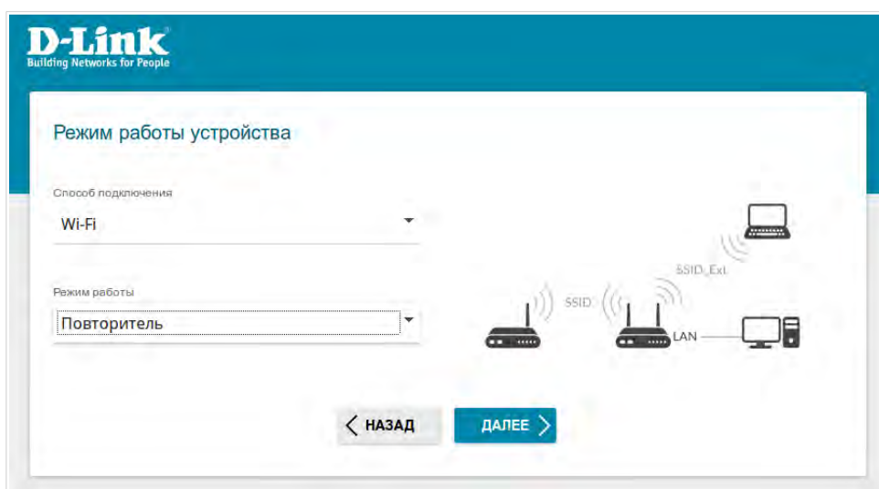
Рисунок 28. Выбор режима работы устройства. Режим Повторитель.
