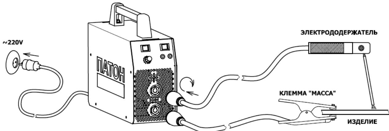
**Рис.2. Схема подключения аппарата для сварки штучными электродами**
