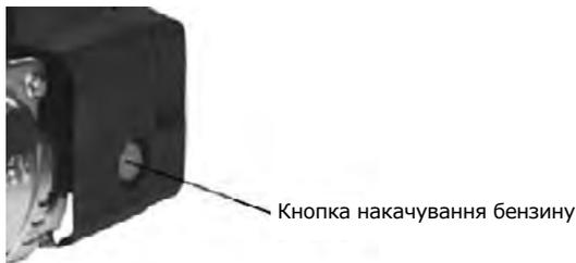
При повторному запуску двигуна натискайте червону кнопку не більше 3-х разів. При надмірному натисканні можливе zalиття бензином свічки запалювання – двигун не заведеться.
