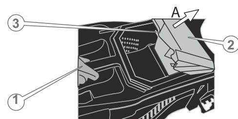
Чтобы подсоединить травосборник к деке газонокосилки, необходимо одной рукой взяться за ручку (1) на крышке контейнера, а второй рукой оттянуть клавишу-фиксатор крышки (2) в направлении стрелки (A) и аккуратно подсоедините травосборник к газонокосилке. При этом пазы на контейнере должны войти в надежное зацепление с выступами на деке (3). Убедитесь в надежности фиксации травосборника.
