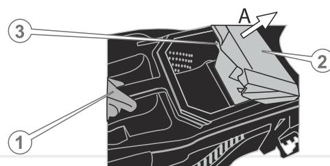
Щоб під'єднати травозбірник до деки газонокосарки, необхідно однією рукою взятися за ручку (1) на кришці контейнера, а другою рукою відтягнути клавішу-фіксатор кришки (2) у напрямку стрілки (A) і акуратно під'єднати травозбірник до газонокосарки. При цьому пази на контейнері повинні увійти в надійне зачеплення з виступами на деці (3). Переконайтесь в надійності фіксації травозбірника.
