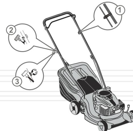
1. Закріпіть на рукоятці оператора трос дроселя за допомогою фіксатора (1) і надійно затягніть гвинт.
