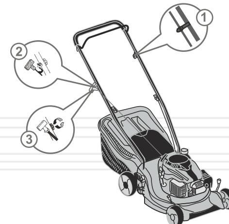
1. Закрепите на рукоятке оператора трос дросселя при помощи фиксатора (1) и надежно затяните винт.
