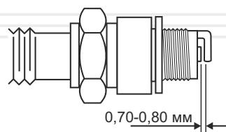
Необхідно регулярно очищувати і перевіряти працездатність свічки запалювання. Несправна чи брудна свічка запалювання або свічка, яка має нагар, стає причиною важкого запуску і поганої роботи двигуна газонокосарки.
