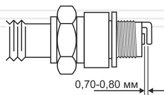
Необходимо регулярно чистить и проверять работоспособность свечи зажигания. Неисправна, грязная или имеющая нагар свеча зажигания становится причиной тяжелого запуска и плохой работы двигателя газонокосилки.
