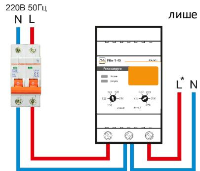
4.5 У разі відхилення рівня напруги за встановлені межі, навантаження відключається. Індикатор «аварія» сигналізуватиме про вихід напруги за допустимі межі, а дисплей перейде у режим миготіння з індикацією рівня напруги.
