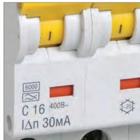
Индикатор состояния главной цепи предоставляет точную информацию о состоянии контактов независимо от положения рукоятки. Номинальный условный ток короткого замыкания – 6000 А. Расширенный диапазон рабочих температур от  $-25$  до  $+40$  °С.
