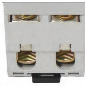
Насечки на контактных зажимах снижают тепловые потери и увеличивают механическую прочность соединения.
