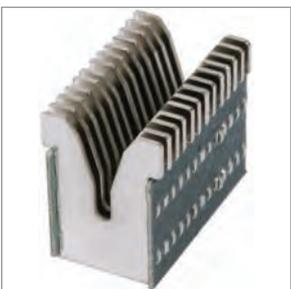
Дугогасительные решетки с увеличенным количеством пластин, расположенные в каждом полюсе, позволяют достичь более эффективное гашение электрической дуги.
