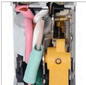
С помощью применения специальных материалов в сердечнике дифференциального трансформатора удалось создать дифференциальный выключатель типа А без применения электронных компонентов.
