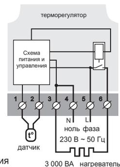
Схема 1. Схема подключения и упрощенная внутренняя схема
