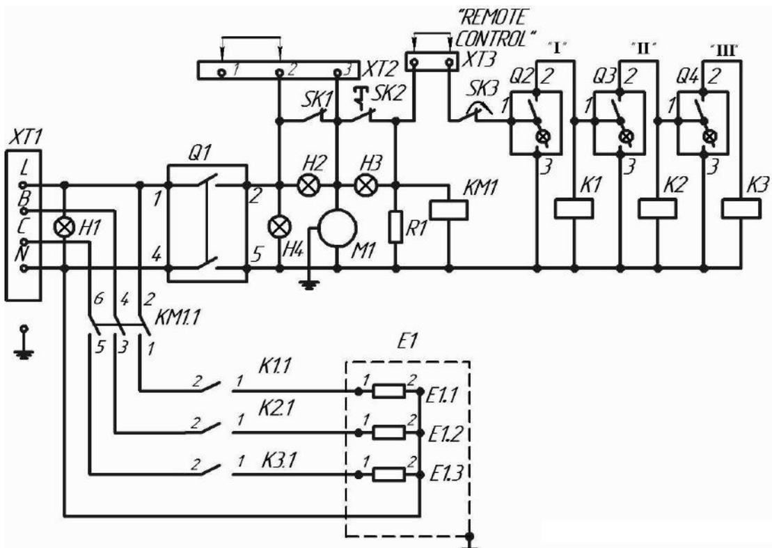
Малюнок 5 – Електричні схеми котлів Eco-Heater 4,5 ÷ 6E
