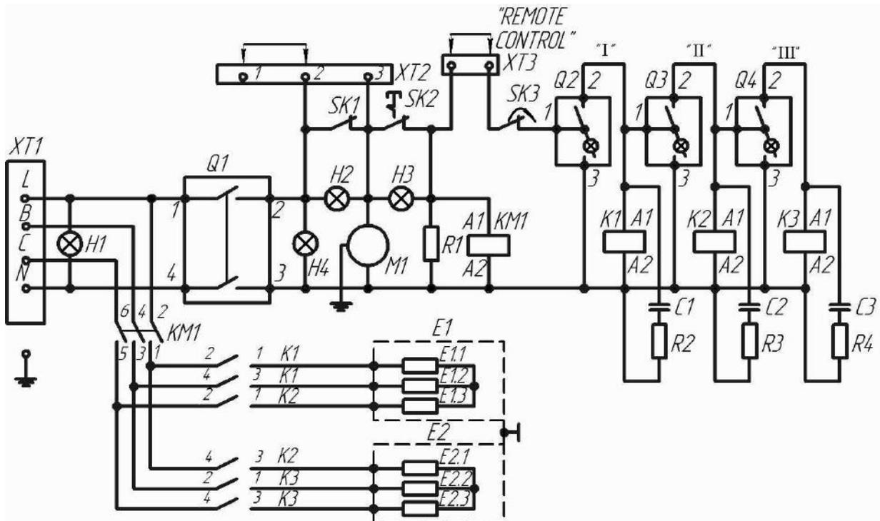
**Малюнок 6 – Електричні схеми котлів Eco-Heater 9 ÷ 18E**
