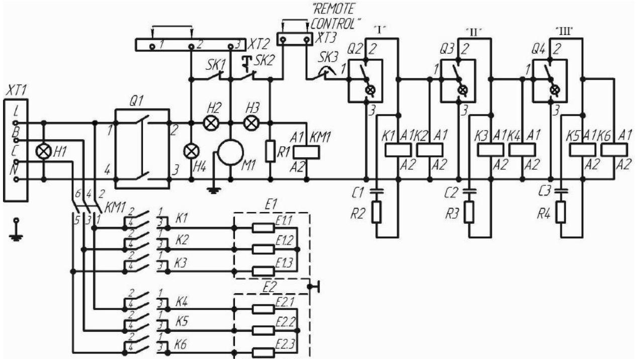
**Малюнок 7 – Електричні схеми котлів Eco-Heater 24 ÷ 30E**
