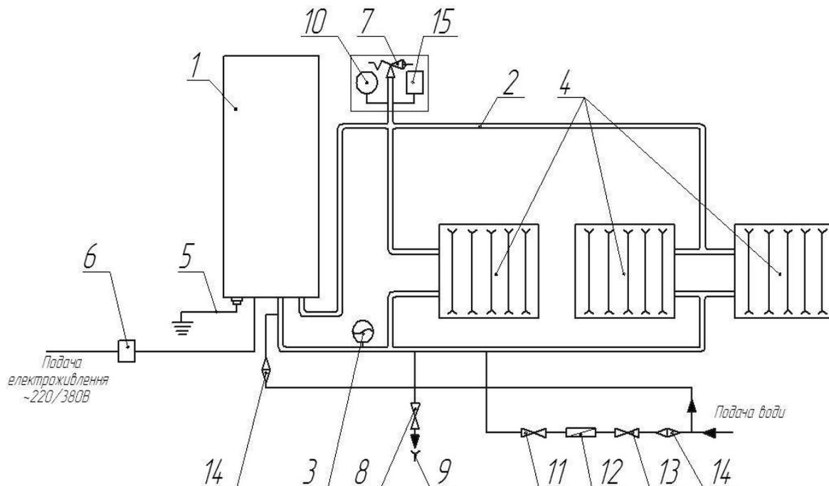
**Малюнок 4 – Рекомендована схема підключення котла до системи опалення**
