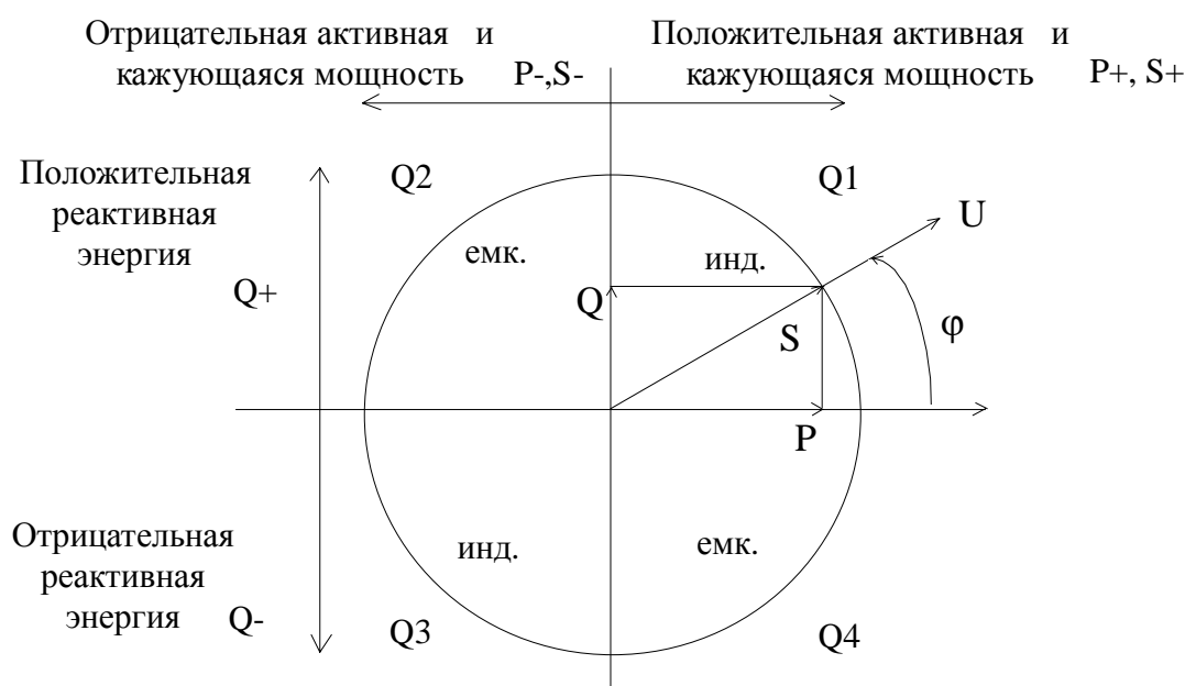
Рис.1. Определение квадранта при измерении мощности
