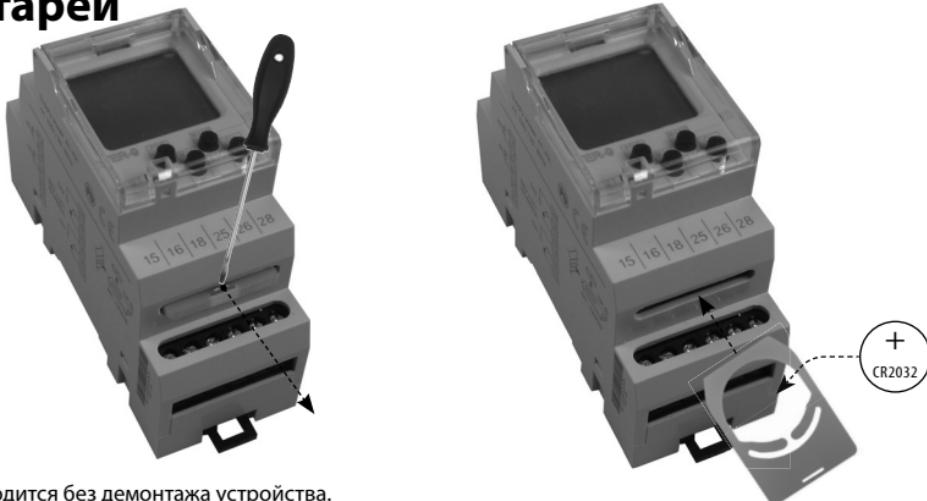
Замена батареи производится без демонтажа устройства.
