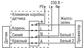
Рисунок 18 – Схема подключения датчиков типов ДД-017, ДД-019
