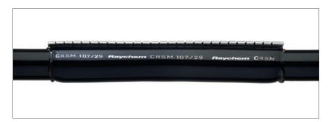
Галогено-чистые ремонтные оборачиваемые манжеты CRSM предназначены для быстрого и надежного ремонта поврежденных пластмассовых или металлических оболочек кабелей и восстанавливают электрическую и механическую целостность кабеля. На внутренней поверхности манжет нанесен термоплавкий клей.
