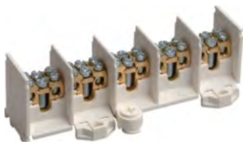
Клемник вводно/розгалужуючий 5-полюсний, 80А на полюс, 25мм 2
